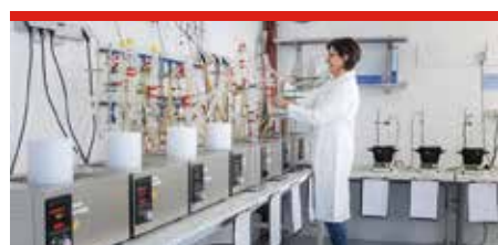
Mithilfe von Ölbädern, Autoklaven und Magnetrührwerken können auch aggressive Kraftstoffe und inhomogene Blow-by-Gas-Gemische bei erhöhten Temperaturen geprüft werden (Bild: O-Ring Prüflabor Richter GmbH)
